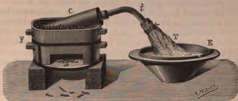
Fig. 253. — Distillation du mercure.
